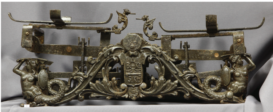
Весы системы Беранже. Для грузов до 5 кг. Фирма ВеберЪДене и К°. Европа, первая пол. XX в. Декорированы мотивами: «русалки», «листья».
