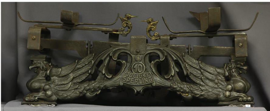
Весы системы Беранже. Для грузов до 10 кг. Фирма Sperling. Польша, нач. XX в. Декорированы мотивами: «грифон», «листья», «птицы».
